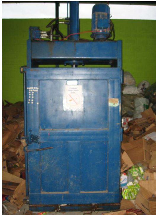
Figura 69 - Prensa para o enfardamento do material reciclável
