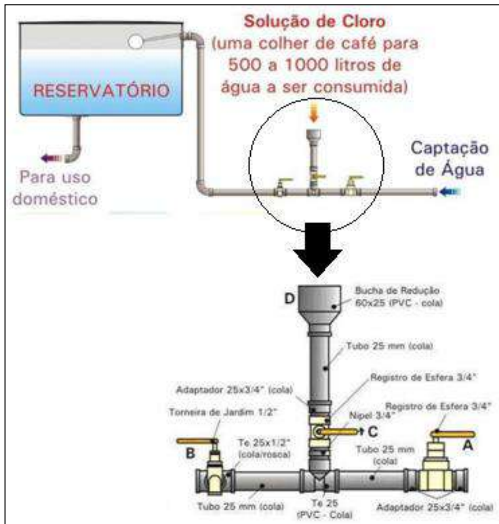
Figura 14 - Esquema do sistema de cloração desenvolvido pela Embrapa
