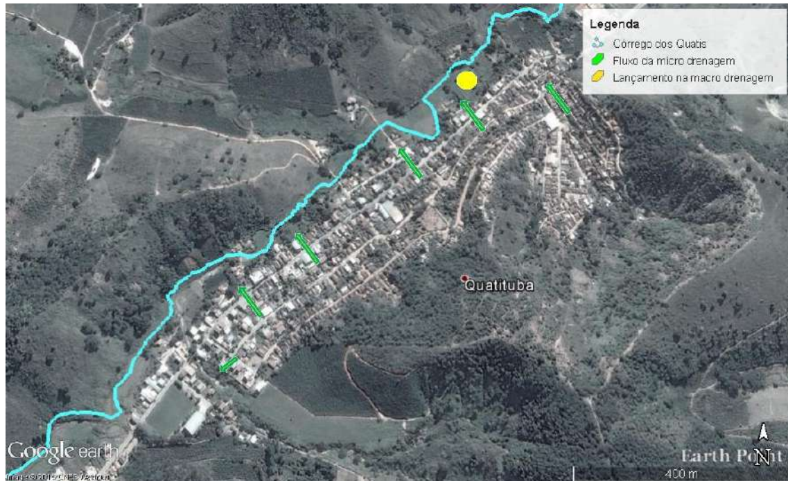
Figura 58 - Fluxo lançamento da drenagem de Quatituba
